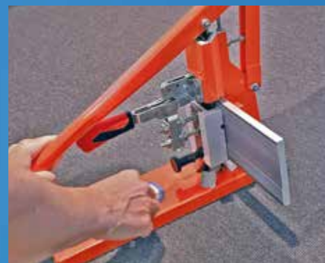
Ecken können gestanzt werden les coins peuvent être poinçonnés
